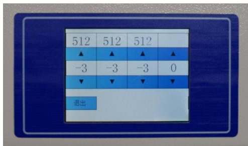
首先，移交机组，并与静电荷板表保持 300mm 左右的距离（或 900mm 以内的要求距离，以确保静电消除性能良好）在触摸屏上。按"向上"和"向下"按钮，测试并调整触摸屏上的离子平衡值。调整后，屏幕上显示的数据将由静电电荷计测得的数据。其他距离校准的步骤相同。工作距离更改时，需要此操作。
