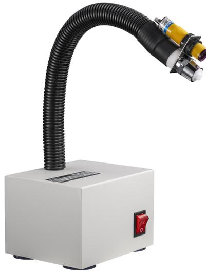
JH4003AF 感应式离子风蛇是一种坐立式消除静电的专用设备。是使用压缩气系列的除静电产品的一种。可手动将蛇管变形使风嘴指向目标方位,让离子气流直接吹向目标表面。内置高压发生器与机身合为一体,方便移动安放于各种工作区域。气流控制器(节流阀)控制气流大小。
