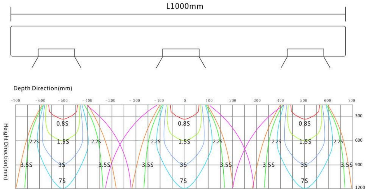
测试条件：**1KV - 0.1KV** 风量开到最大
